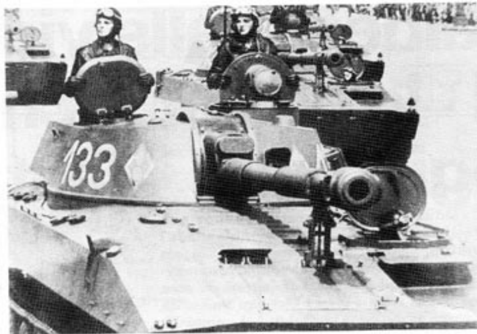
Många sovjetiska vapen möjliggörs av västerländsk teknologi. Exempelvis precisionskullager, där modellerna ibland hämtas från Sverige. På bilden en amfibisk 12,2 cm handhaubits av sovjetisk modell.
