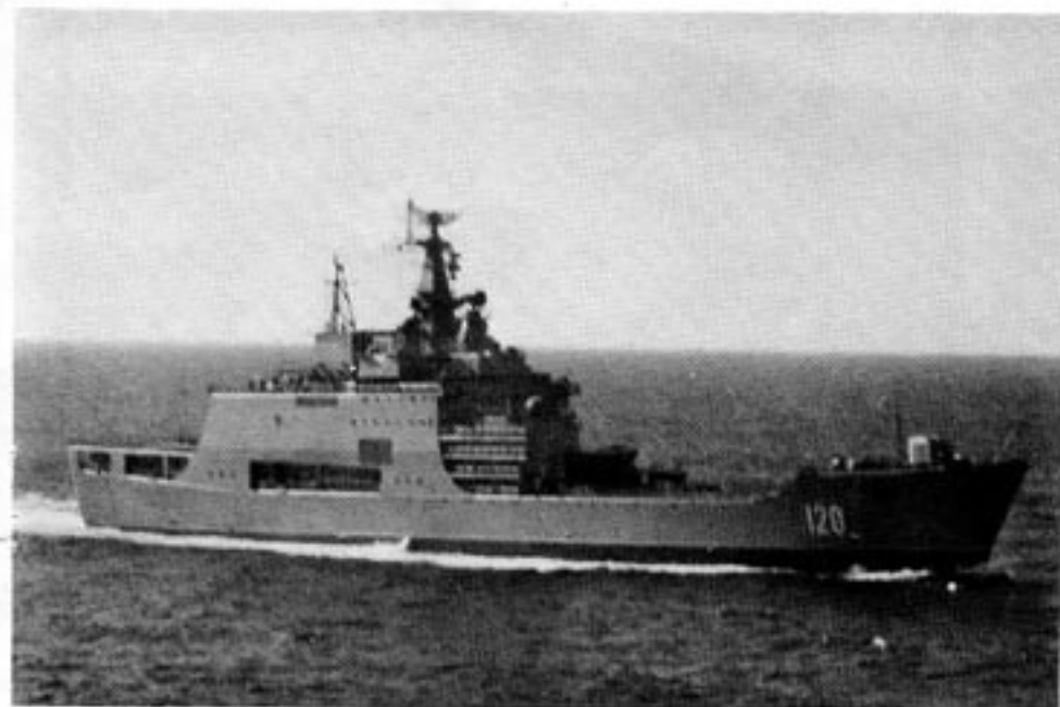
Amfibieattackfartyget "Tvan Rogov". Fartyget är specialkonstruerat för landstigningsoperationer i stor skala. Det lastar en hel pansarbataljon och är bestyckat med kanoner och luftvärnsrobotar.
