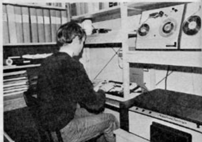
Sättning pågår. Arbeta pågår vid tangentbordet. Uppa till höger syns de två bandspelarna, som lagrar texten på magnetband. Ett nummer av Contra rymms på ett vanligt sjutums bandspelarband. Nere till höger syns centralenheten med mikrodatator, roterande skiva, blixtlampa och film. Hela anläggningen, i fyra delar, väger 45 kg. Utöver de delar som syns på bilden behövs framkallningsutrustning för att framkalla filmen.
